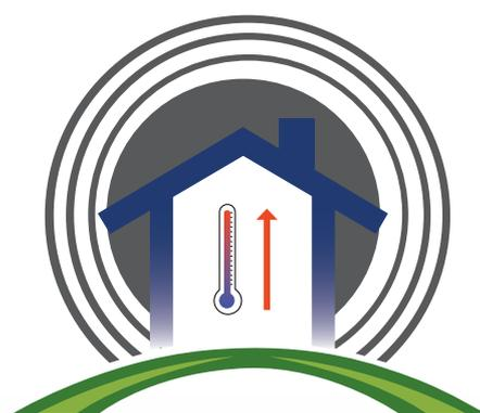
Al diminuire della temperatura esterna aumenta quella del sistema di riscaldamento.
