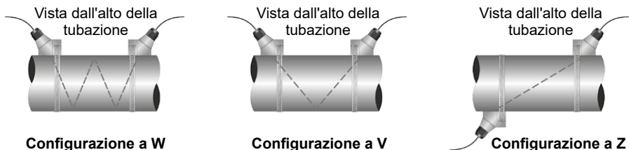
Fig. 8 - Configurazioni dei trasduttori di portata UTT10-050S, UTT10-050L e UTT10-050H
