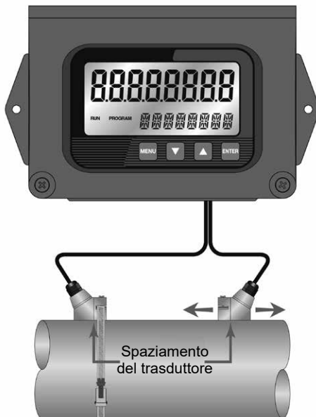
Fig. 12 - Posizionamento del trasduttore
