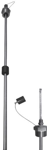
Modello indicato per applicazioni in serbatoi senza indicatore che richiedano la lettura manuale, visiva del livello. Per la lettura del livello si utilizza un nastro graduato inserito all'interno dell'asta: estraendo lentamente il nastro si rileva il livello del liquido grazie all'interazione del magnete del galleggiante con il magnete sul fondo del nastro graduato. Galleggianti in acciaio inox o BUNA N, le altre parti a contatto sono in acciaio inossidabile.
