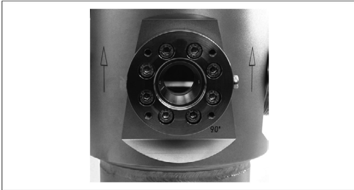
Fig. 19 - Armatura DTF con anello dell'oblò FL59 - 8M5 dell'assieme del rilevatore da 90°
