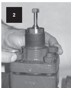
Serrare manualmente i dadi e i bulloni del cappello, avvitandoli a incrocio per rendere il serraggio uniforme.
