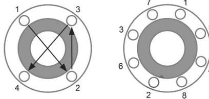
Per garantire l'uniformità del carico e dell'allineamento, i bulloni delle flange devono essere serrati in modo graduale e in sequenza, come indicato in figura.
