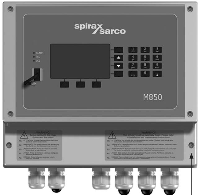
Occhio per il montaggio del lato inferiore (accessibile attraverso lo scomparto delle morsettiere)
