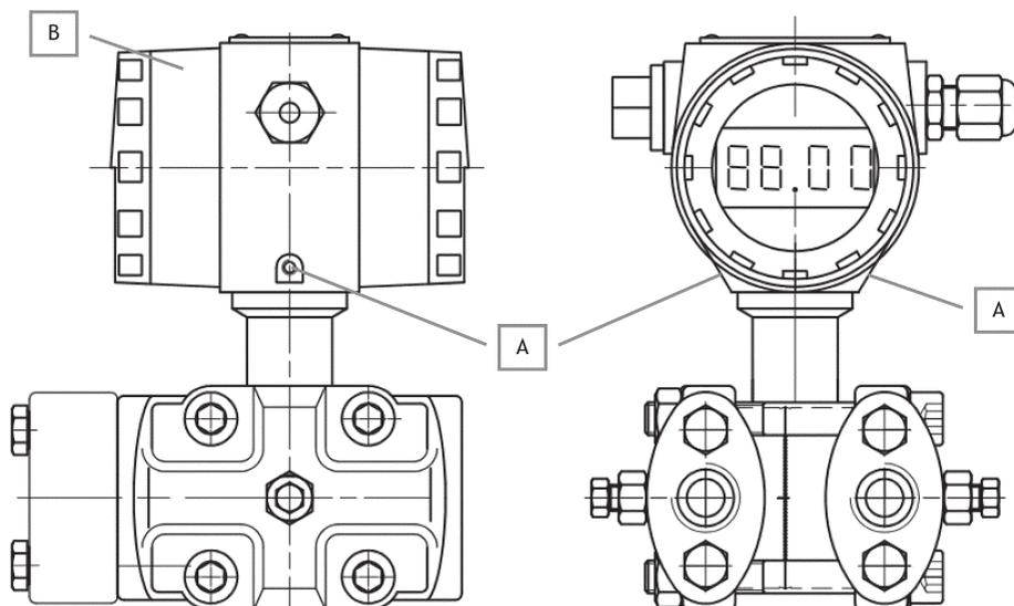
Fig. 8 - Rotazione della testa del trasmettitore
