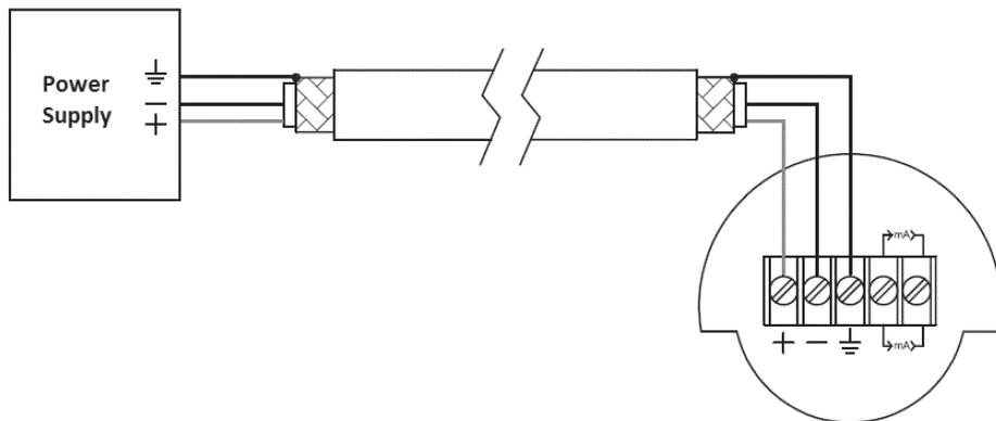
Fig. 16 - Messa a terra della calza per cavi di lunghezza superiore ai 20 metri
