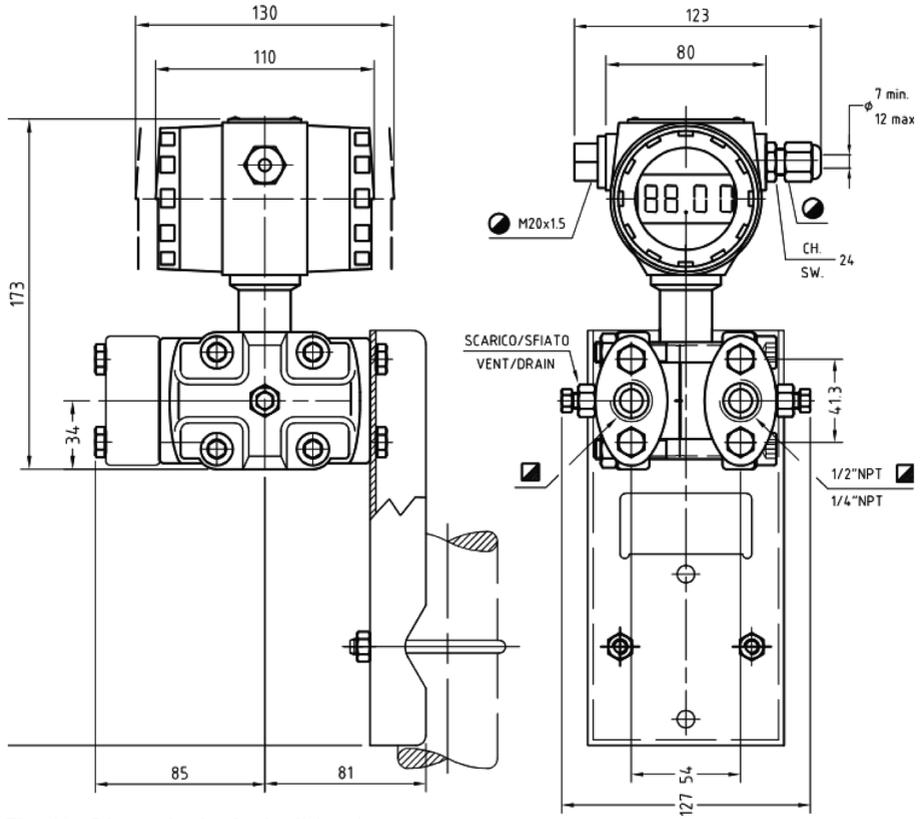
Fig. 19 - Dimensioni principali (mm)
