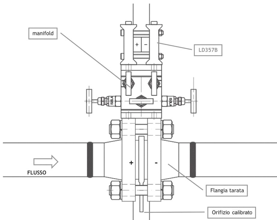
Fig. 7 - Misura della pressione differenziale in tubazioni (in questo caso portata)
