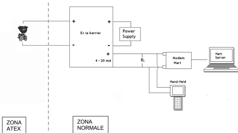
Fig. 11 - Collegamento al modem con uscita 4÷20 mA + Hart® con barriera Ex ia
