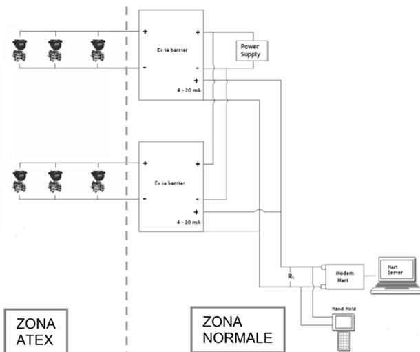
Fig. 12 - Collegamento in multidrop con solamente uscita Hart®
