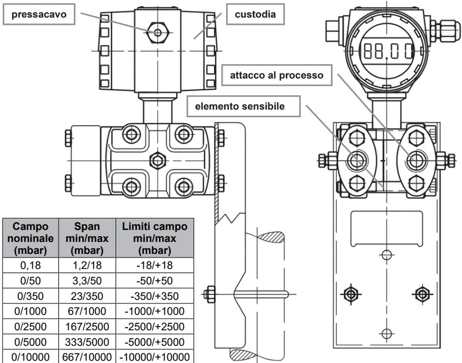
Fig. 1 - Trasmettitore di pressione differenziale LD357B
