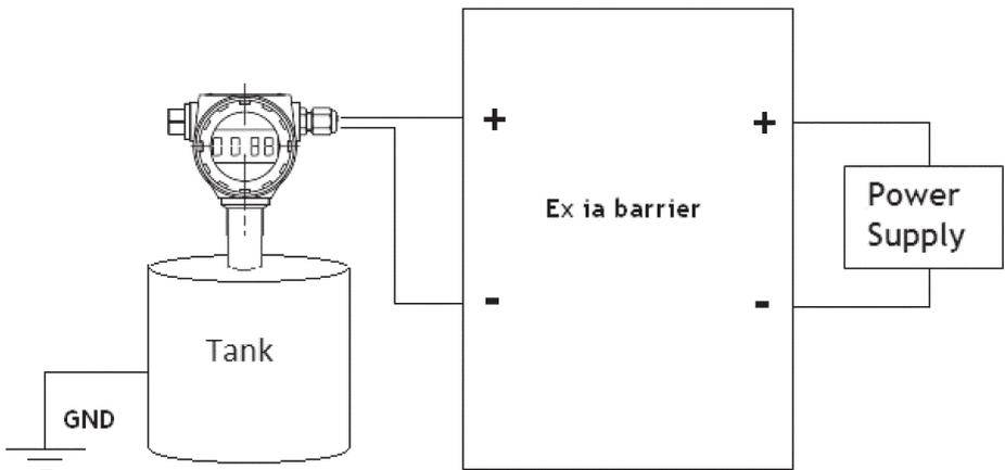
Fig. 14 - Collegamento loop 4÷20 mA con barriera Ex ia
