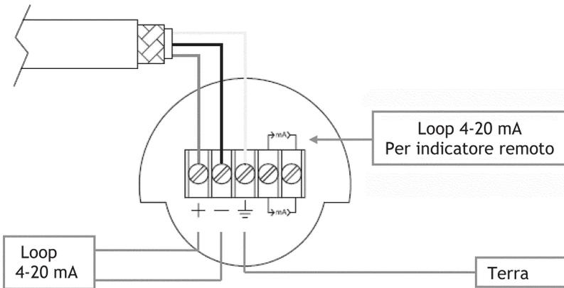
Fig. 9 - Collegamento cavo alimentazione a morsettieria
