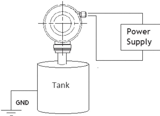
Fig. 8 - Collegamento loop 4±20 mA con impianto provvisto di messa a terra
