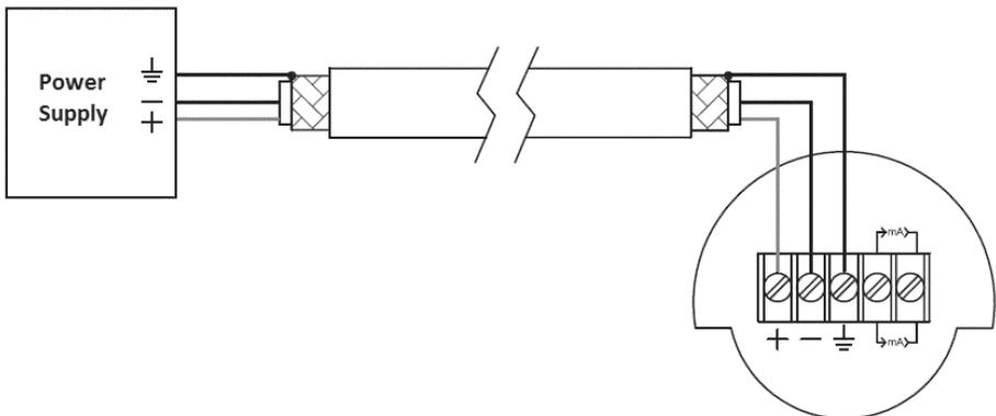
Fig 10 - Messa a terra della calza per cavi di lunghezza superiore ai 20 metri
