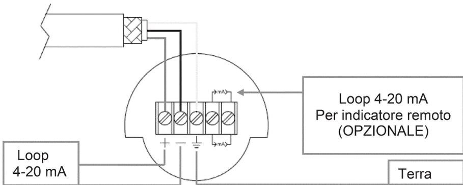
Fig. 3 - Collegamento cavo alimentazione a morsettieria
