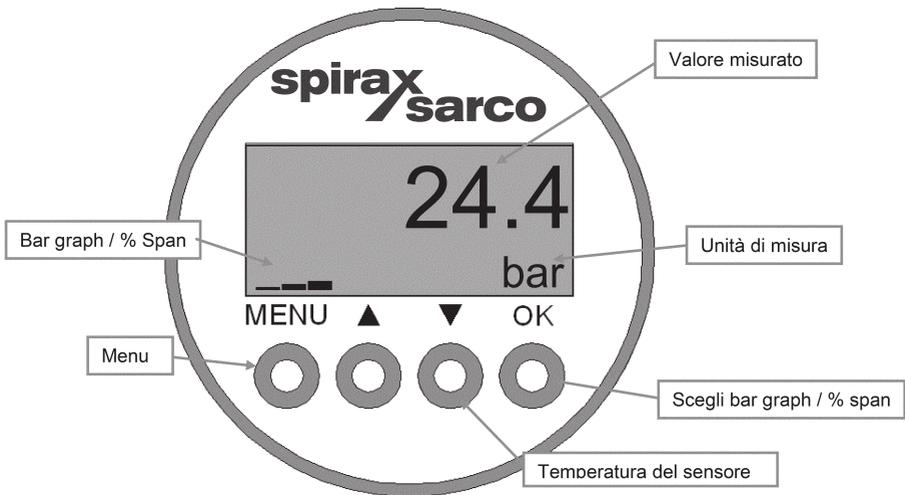
Fig. 11 - Display del trasmettitore LD276
