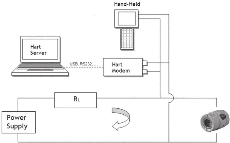
Fig. 5 - Collegamento al modem con uscita 4÷20 mA + Hart®
