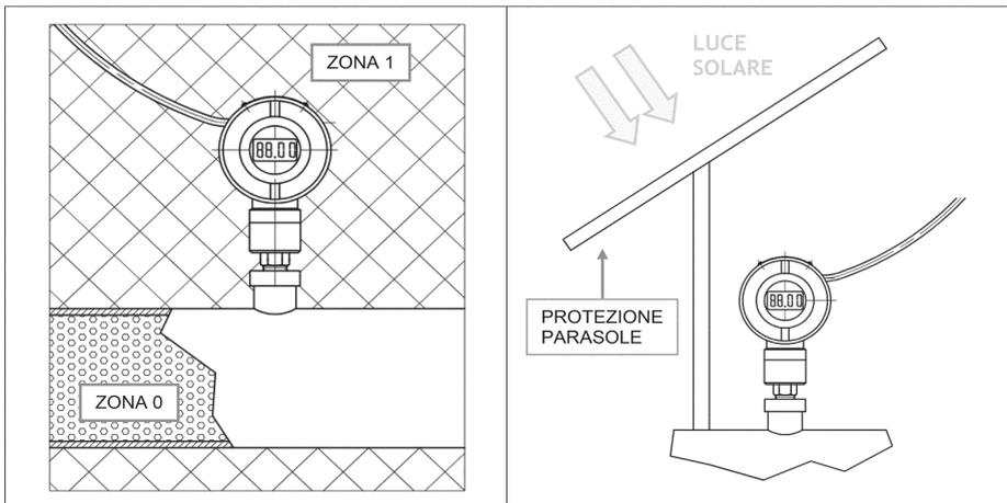
Fig. 2 - Requisiti di montaggio
