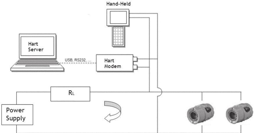
Fig. 6 - Collegamento in multidrop con solamente uscita Hart®
