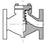
Fig. 3 RJ216Z Check valve
