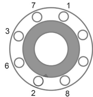
Per garantire l'uniformità del carico e dell'allineamento, i bulloni delle flange devono essere serrati in modo graduale e in sequenza, come indicato in figura.
