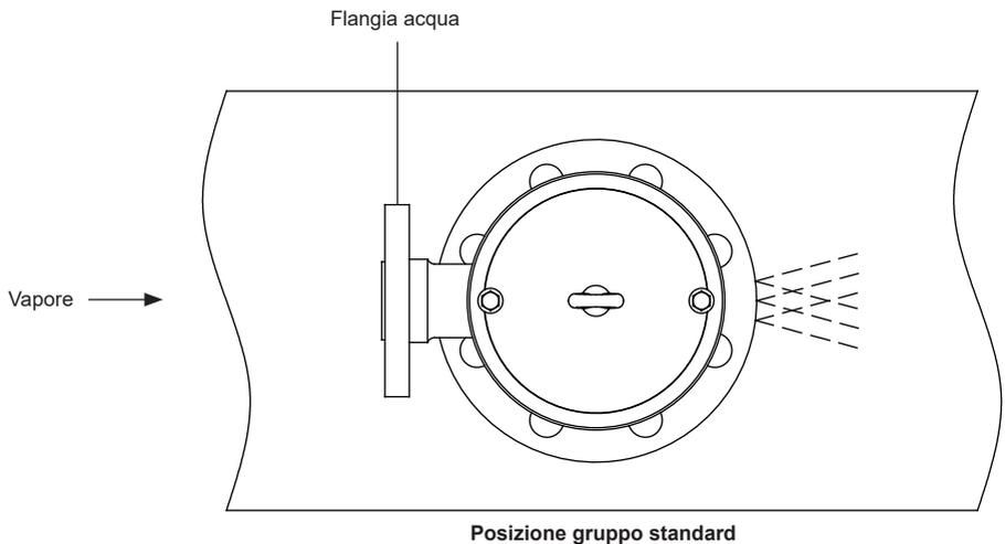
Fig. 5 Connessione acqua
