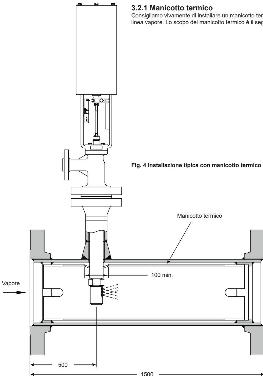
Fig. 4 Installazione tipica con manicotto termico
