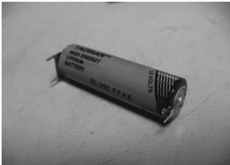
**8.3.8** Infilare una fascetta di fissaggio nuova nei due appositi fori ricavati sulla PCB, collocarvi in mezzo la nuova batteria e, dopo aver chiuso e serrato bene la fascetta, tagliarne la parte eccedente.
