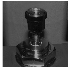
Fig. 17 Montaggio corretto - impegnati 8 millimetri del filetto
