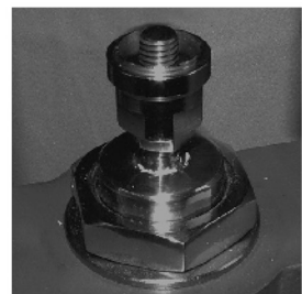
Fig. 18 Montaggio errato - il filetto sporge dall'adattatore
