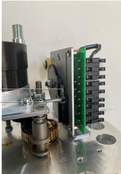
Fig. 8 Disposizione del feedback degli interruttori ausiliari di finecorsa (WE) (1-6 kN)
