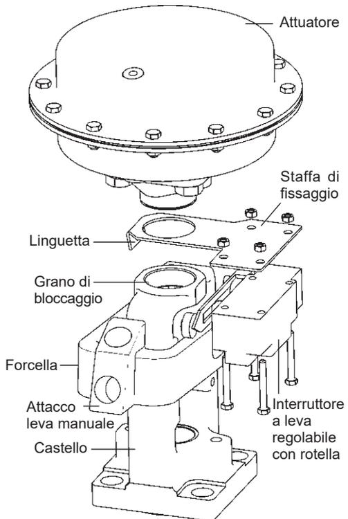
Fig. 3 - Montaggio interruttore di finecorsa
