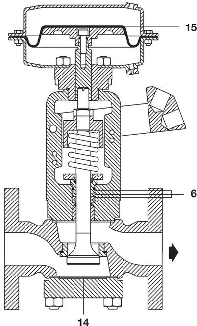
Fig. 7 - DFG300A da DN32 a DN50
