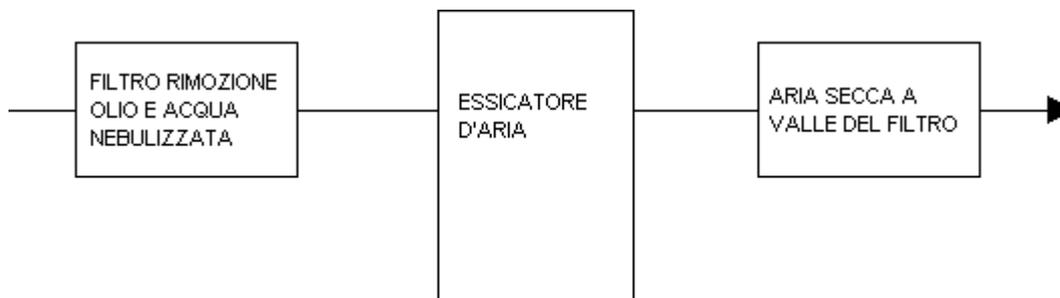
Fig. 5.7 Sistema di trattamento qualità dell'aria
