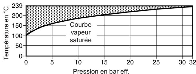
Cet appareil ne doit pas être utilisé dans la zone hachurée pour des raisons électroniques.
