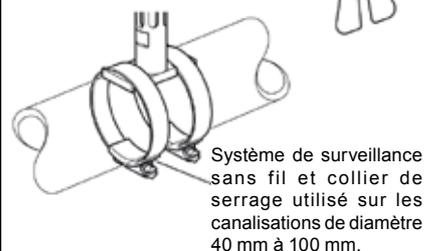
Système de surveillance sans fil et collier de serrage utilisé sur les canalisations de diamètre 40 mm à 100 mm.
