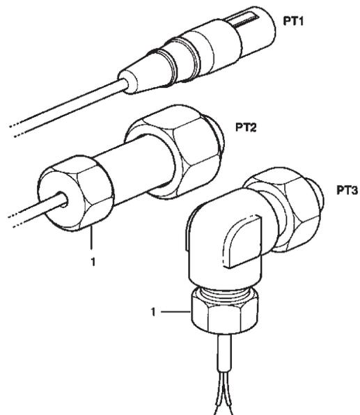
Note : le type de câble n'est pas primordial. Un câble avec conducteurs de 9/10 mm ou avec torons composés de 7 fils de 2/10 mm conviendra.
