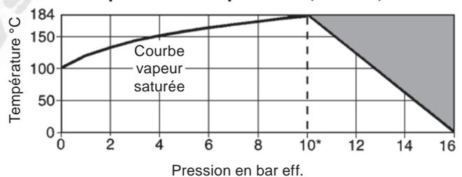
Cet appareil ne doit pas être utilisé dans la zone ombrée
