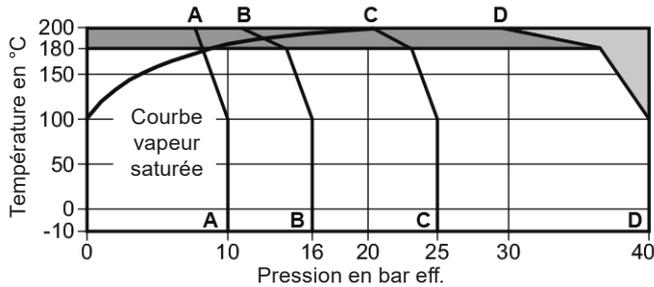
Cet appareil ne doit pas être utilisé dans cette zone au-dessus des conditions de calcul du corps données dans le tableau ci-dessous sans risquer d'endommager les pièces internes.
