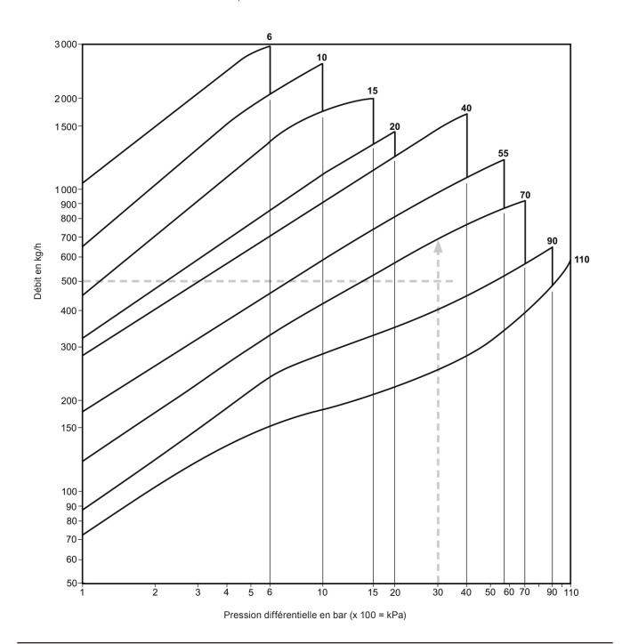
Nota: Les purgeurs à flotteur inversé ouvert IBV doivent être sélectionnés pour une utilisation à une pression différentielle de fonctionnement la plus appropriée et non sur la base du débit.
