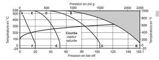
Cet appareil **ne doit pas** être utilisé dans cette zone ou au delà des limites de la PMA ou TMA en fonction des raccordements.
