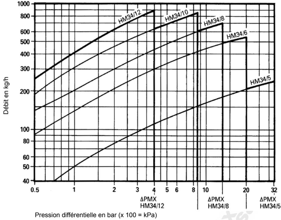
**Nota :** Un purgeur doit être sélectionné en fonction de sa pression différentielle et non sur la base du débit ; par exemple un HM34, DN25 avec un débit de 80 kg/h et une pression différentielle de 7 bar, on préférera le HM34/10 au HM34/5.
