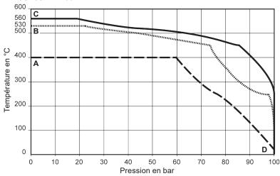
Cet appareil ne doit pas être utilisé au delà de la courbe de pression/température correspondant à chaque matériaux.
