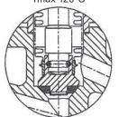
Clapet avec portée souple PTFE ou NBR - Tmax 200°C
