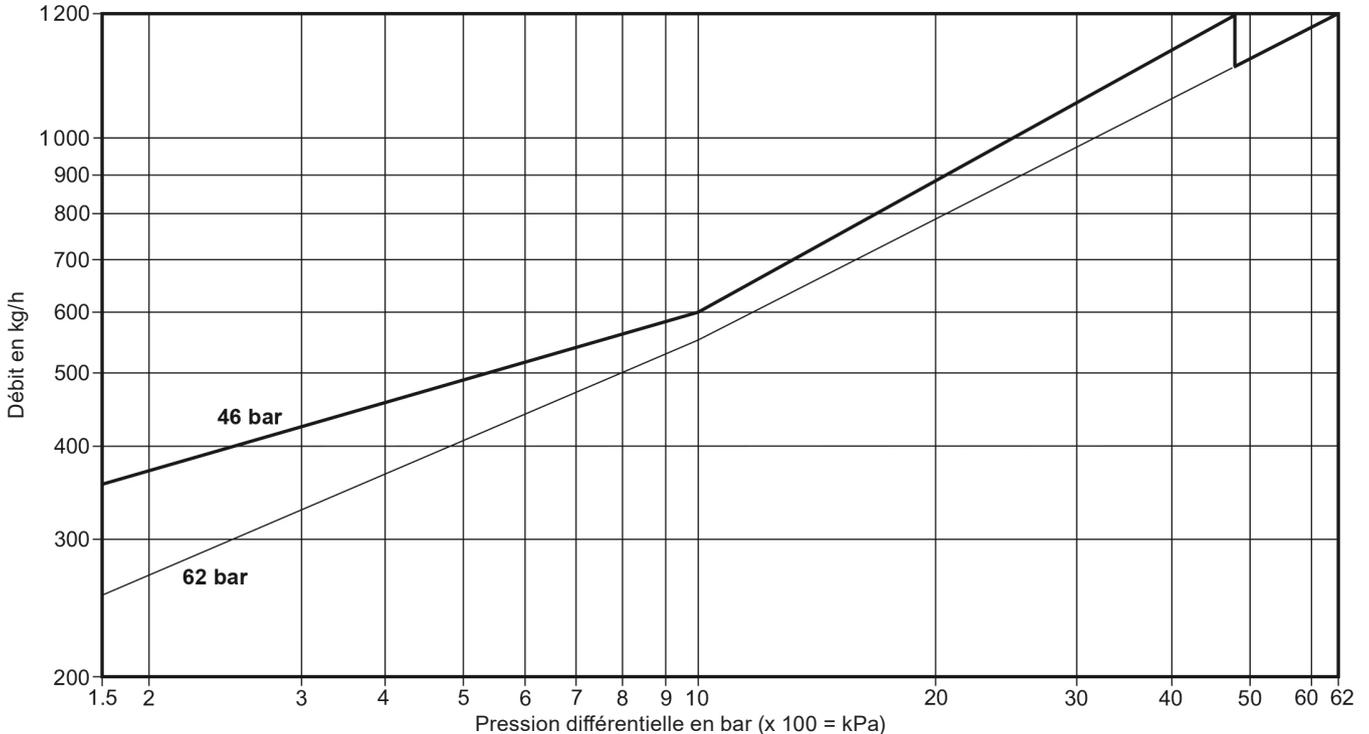
Les débits indiqués ci-dessus sont basés sur un refoulement de condensat à température de la vapeur saturée. Sous des conditions de démarrage à froid, le purgeur d'air bimétallique interne qui est ouvert fournit un débit supplémentaire au clapet principale. Le tableau suivant donne le débit additionnel minimum d'eau froide à partir du purgeur d'air sur tous les diamètres.
