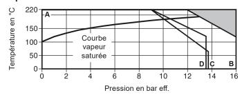
Cet appareil ne doit pas être utilisé dans cette zone.
