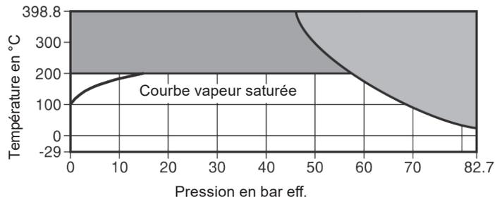
Cet appareil ne doit pas être utilisé dans cette zone.
