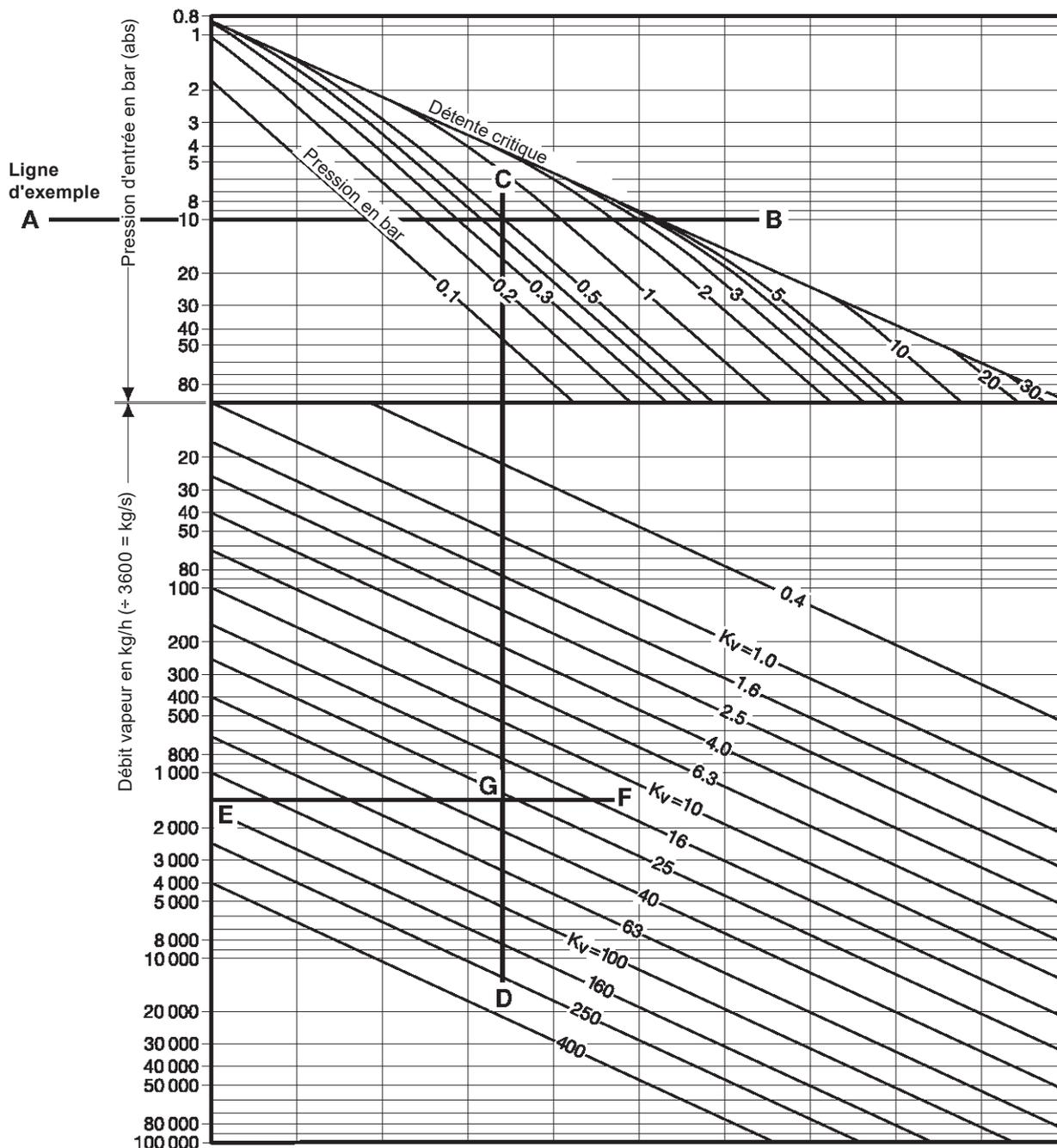
Le diagramme de dimensionnement est empirique et ne doit pas être utilisé pour les applications critiques
