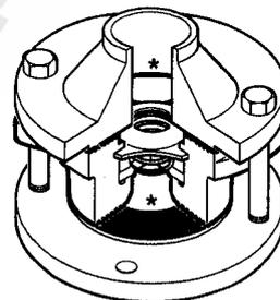
\*Nota : les brides, les boulons (ou écrous), les vis et les joints sont fournis par l'installateur. Le clapet de retenue DCV 1 est indémontable (aucune pièce de rechange est disponible) et il ne convient pas sur des circuits où le débit est soumis à de fortes pulsations (proximité d'un compresseur).
