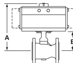
\*Nota : Les dimensions **A** et **B** représentent les dimensions maximales (mm) pour l'actionneur de plus grand DN recommandé convenant avec chaque robinet.
