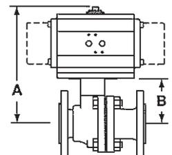
\*Nota : les dimensions **A** et **B** représentent les dimensions maximales (mm) pour l'actionneur de plus grand DN recommandé convenant avec chaque robinet.
