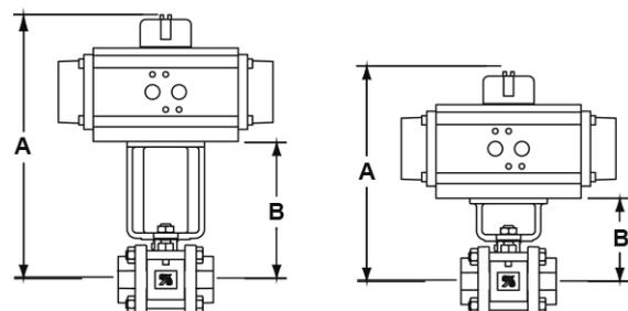
\*Nota : Les dimensions A et B représentent la taille maximale (mm) pour le plus grand actionneur recommandé selon chaque vanne.
