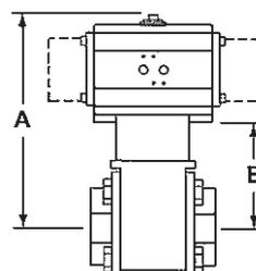
\*Nota : Les dimensions A et B représentent les dimensions maximales (mm) pour l'actionneur de plus grand DN recommandé convenant avec chaque robinet.
