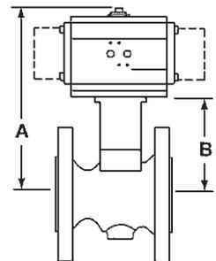
\*Nota : Les dimensions A et B représentent les dimensions maximales (mm) pour l'actionneur de plus grand DN recommandé convenant avec chaque robinet.
