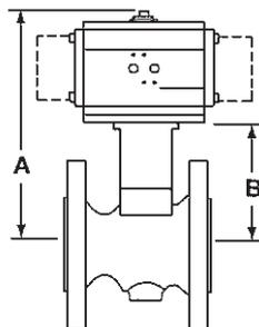
\*Nota : Les dimensions A et B représentent les dimensions maximales (mm) pour l'actionneur de plus grand DN recommandé convenant avec chaque robinet.
