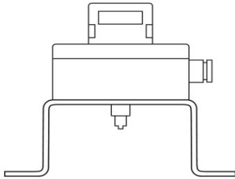
**Electrovanne** : Une gamme d'électro-distributeur NAMUR avec protection IP65 est disponible pour une utilisation avec les actionneurs BVA. Elle peut être utilisée pour piloter l'actionneur avec de l'air comprimé ou du gaz non corrosif.
