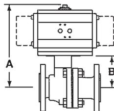
\*Nota : les dimensions A et B représentent les dimensions maximales (mm) pour l'actionneur de plus grand DN recommandé convenant avec chaque robinet.
