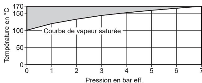
Cet appareil ne doit pas être utilisé dans cette zone sous peine d'endommager les pièces internes.
