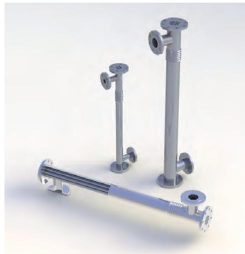
Fabriqué par Spirax Sarco dans son usine d'Italie, le Turflow utilise des tubes corrugués afin d'augmenter l'efficacité thermique côté tubes et côté calandre. De ce fait les échangeurs ont des encombrements réduits pour des échanges thermiques optimums et un encrassement minimisé.
