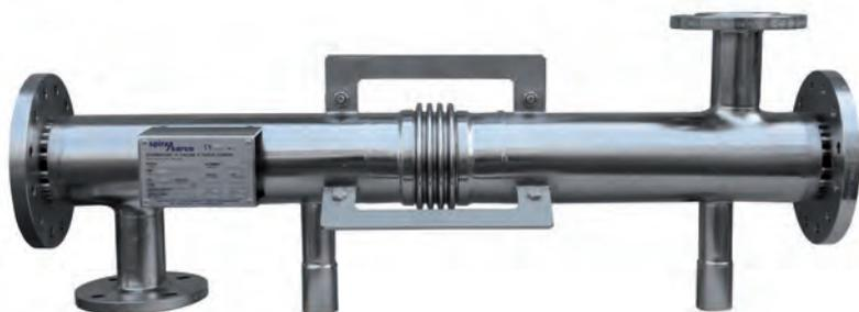
Les échangeurs Spirax Sarco sont de type tubes droits (mono passe ou multi passes). Chaque échangeur est de type double plaque (DTS : Double tube sheet). Cette conception permet d'éviter toute contamination croisée lors d'une rupture aux points de jonction des brides et de visualiser rapidement les fuites.
