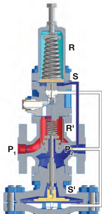
La pression  $P_2$ , présente dans la chambre aval, est transmise au niveau des guides de la tige de clapet principal sur la membrane principale. Nous retrouvons une nouvelle force :
