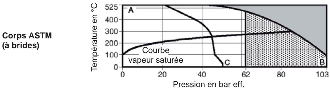
Cet appareil ne doit pas être utilisé dans la zone ombrée.
