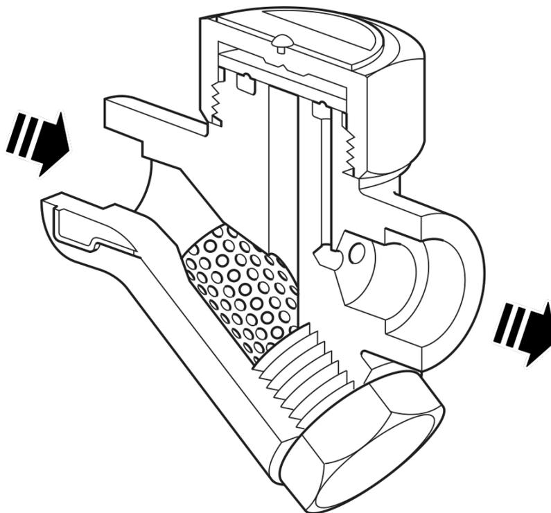
Fig. 1 - Purgeurs thermodynamiques TD42S2
