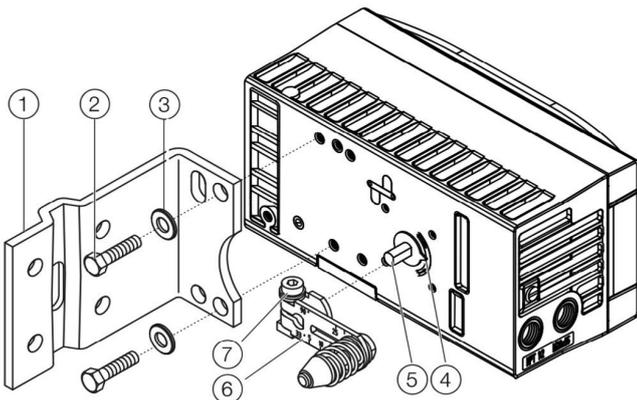
1. Fixer le levier (6) à l'arbre de rétroaction (5) du positionneur (ne peut être monté que dans une seule position en raison de la forme découpée de l'arbre de rétroaction).
