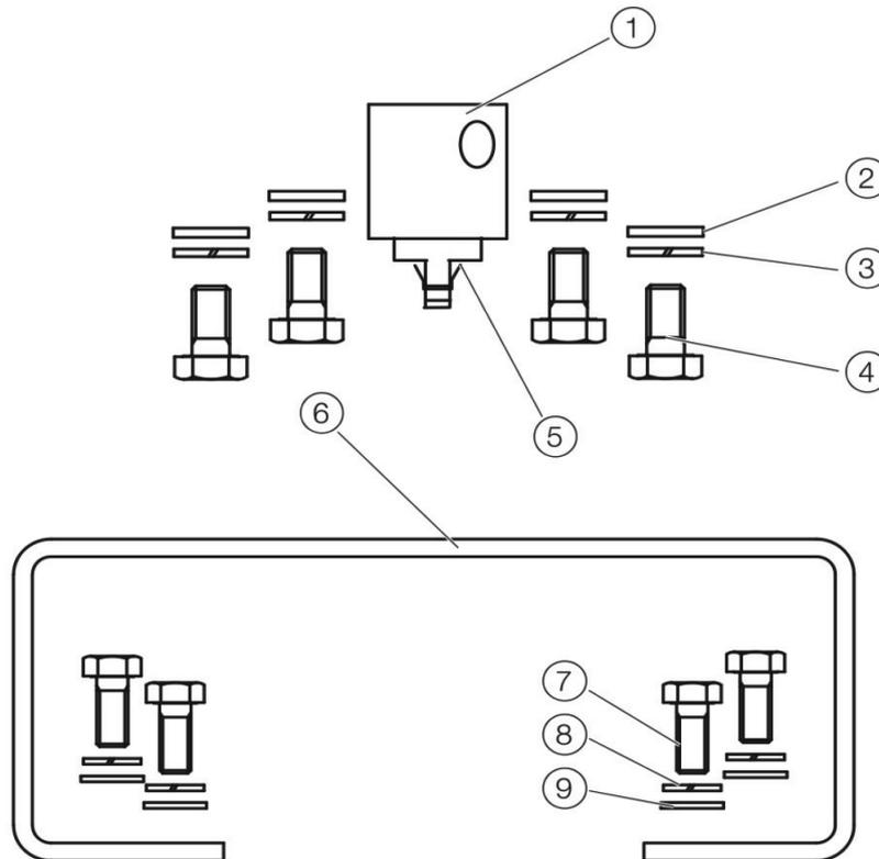
Fig. 12 - Composants du kit de fixation
