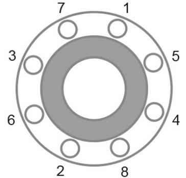
Les boulons de brides doivent être serrés progressivement
