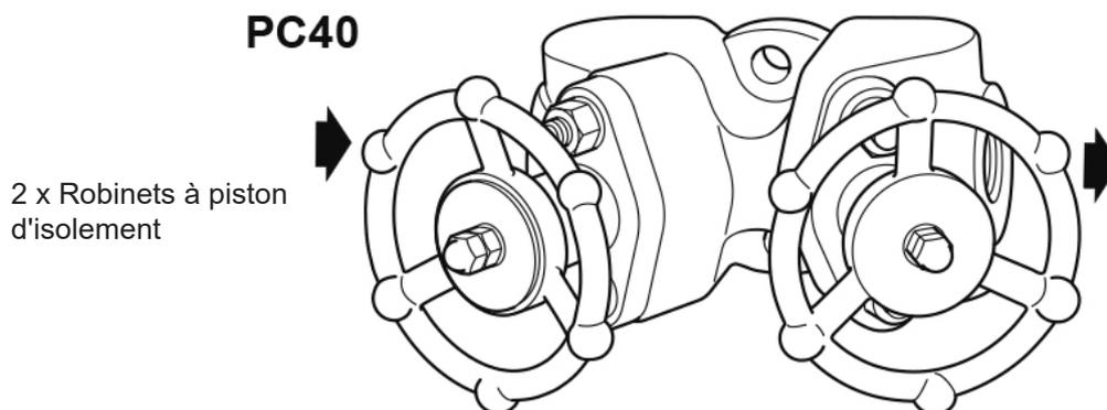
**\*Nota :** La sortie de by-pass / purge de ligne est représentée hors de position pour plus de clarté et que la tuyauterie de la ligne de purge doit être fourni par le client.
