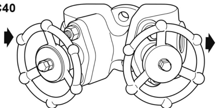
**\*Nota :** La sortie de by-pass /purge de ligne est représentée hors de position pour plus de clarté et que la tuyauterie de la ligne de purge doit être fourni par le client.
