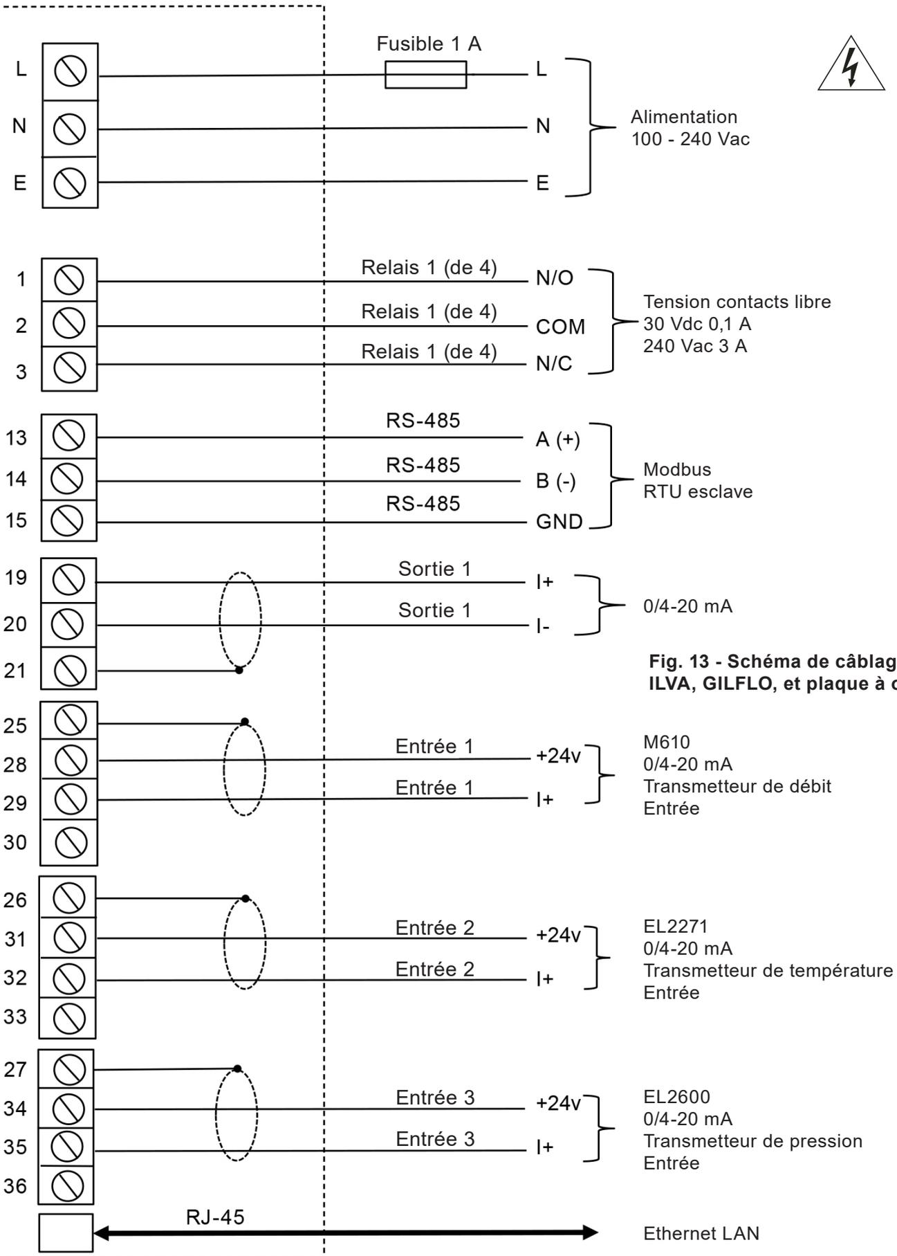
**Fig. 13 - Schéma de câblage ILVA, GILFLO, et plaque à orifice**
