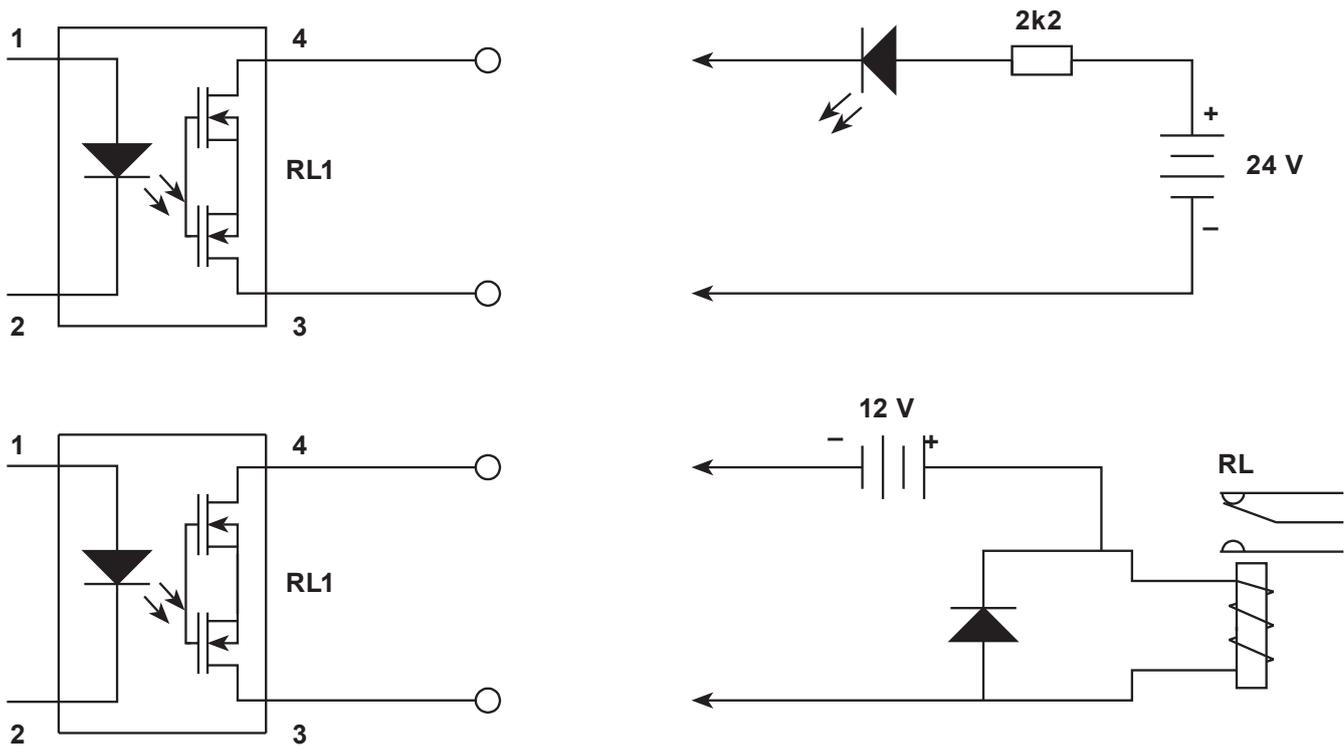
Connexion des récepteurs aux sorties binaires
