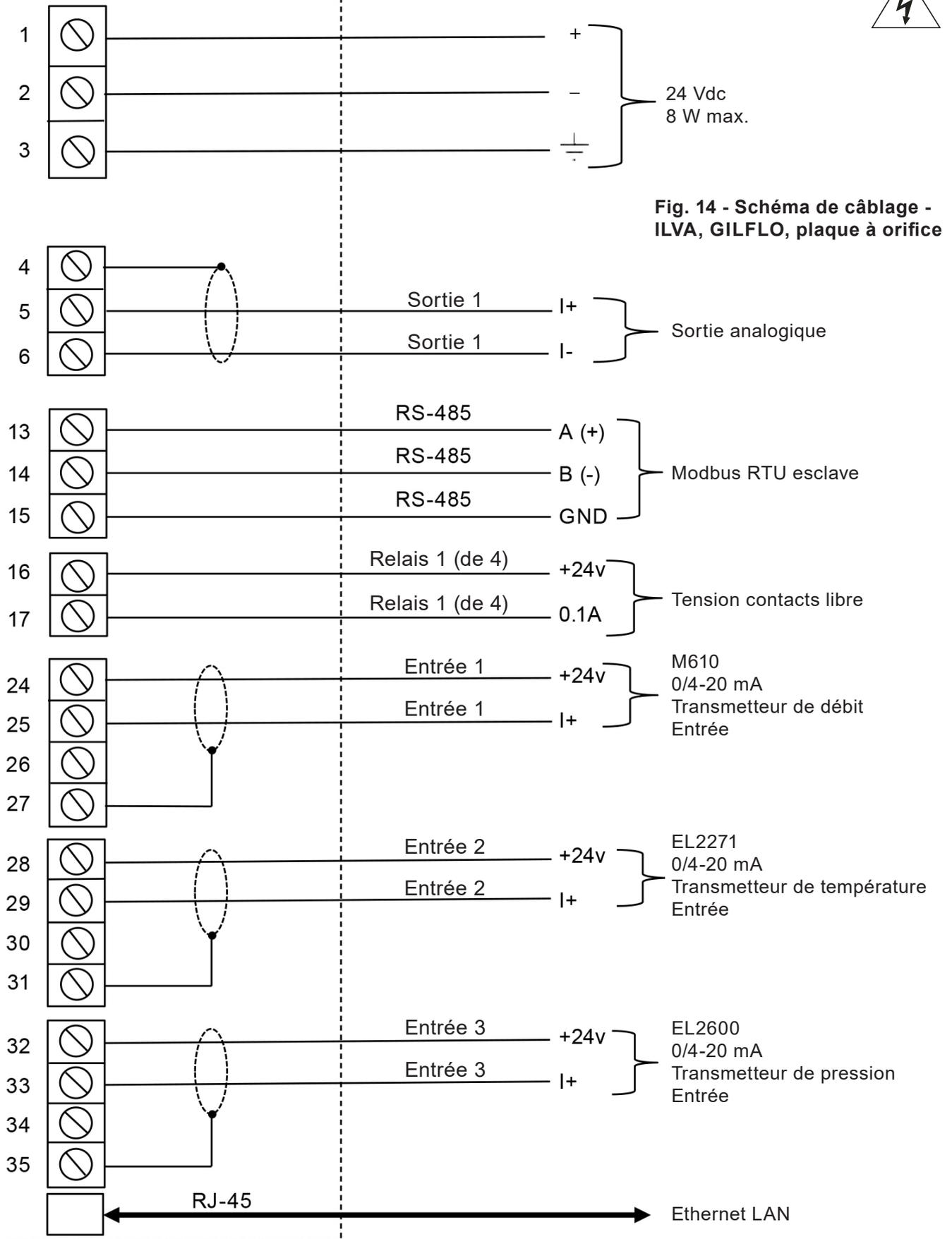
**Fig. 14 - Schéma de câblage - ILVA, GILFLO, plaque à orifice**
