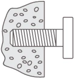
Vis de montage dépassant de la surface pour permettre de glisser la patte de fixation par dessus
