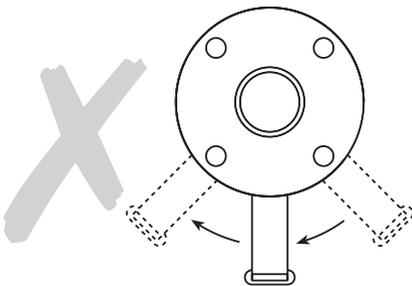
**Fig. 2 - Installation incorrecte pour les applications liquides**
