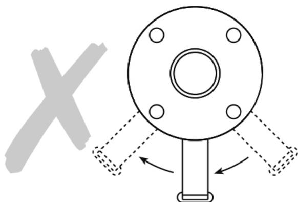
**Fig. 2 - Installation incorrecte pour les applications liquides**
