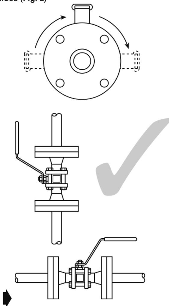
**Fig. 3 Installation correcte pour les applications gaz**
