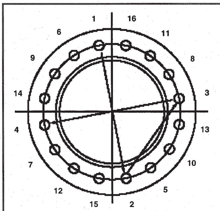
**△ Attention :** Il est très important de suivre correctement l'ordre de serrage des écrous. Dans le cas contraire, les brides peuvent fléchir et laisser passer une fuite. Le serrage incorrect de brides avec un joint spiralé provoque une déformation irréversible du joint et l'apparition d'une fuite.
