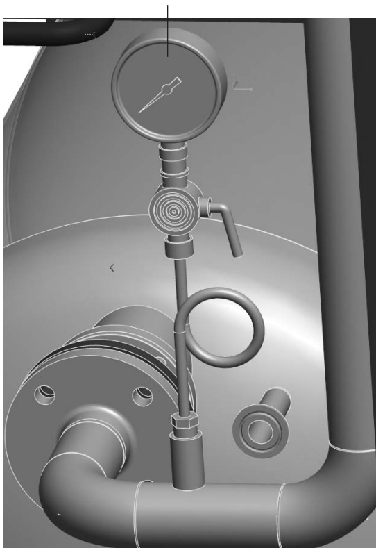
Manomètre sur la ligne eau stérilisée
