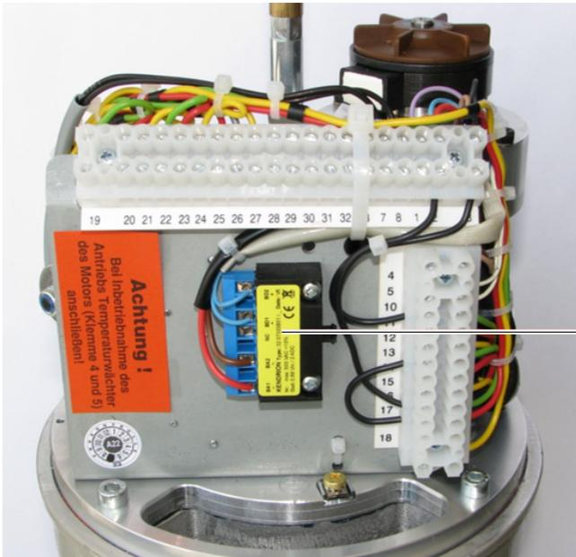
Bornier de l'élément chauffant anti-condensation
