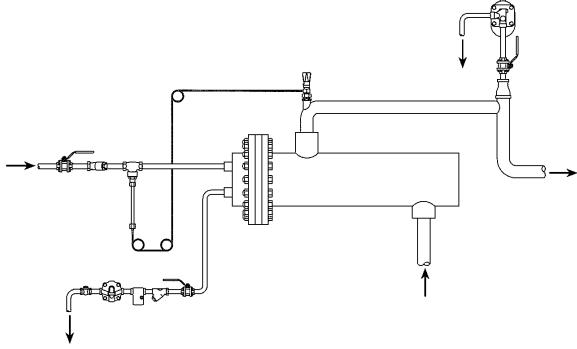
Fig. 3 Installation type utilisant un AE10S sur une boucle de préchauffage de fuel où l'éliminateur d'air est essentiel pour le comptage
