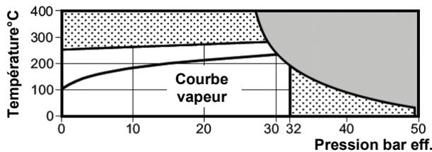
Le purgeur ne doit pas être utilisé dans la zone ombrée.
