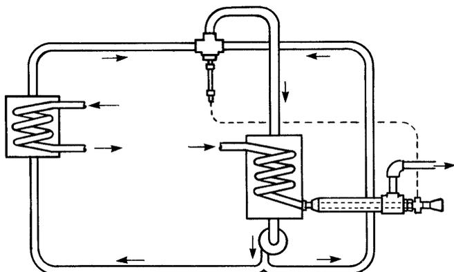
Régulateur TW monté comme vanne mélangeuse sur un circuit d'eau glacée.
