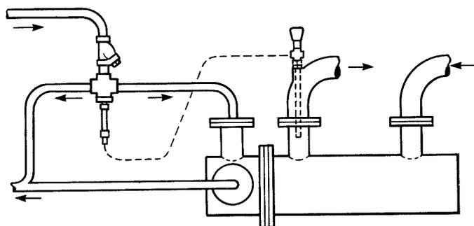
Régulateur TW, monté sur un appareil à contre-courant, alimenté par eau.
